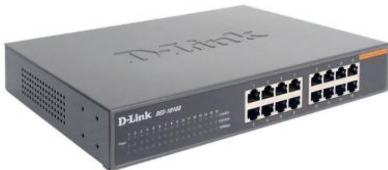
Для того, чтобы разделить одну сеть на несколько разделяемых сред, используют специальное сетевое оборудование, которое называется сетевым коммутатором.
