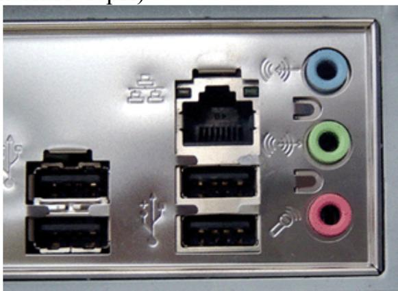
Иногда необходимые для связи компьютеров компоненты уже установлены на системной плате и тогда отдельная сетевая плата не нужна. В этом случае гнездо для сетевого кабеля расположено на задней стенке системного блока.
