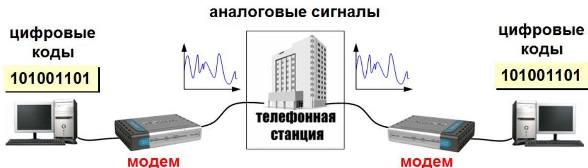
Модем подключает компьютер к телефонной линии. Его настройка производится в программных средах компьютера.
