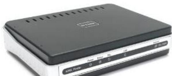
**Внешний модем** – это отдельное устройство, которое подключается к ПК через специальный порт, который имеется у каждого компьютера.
