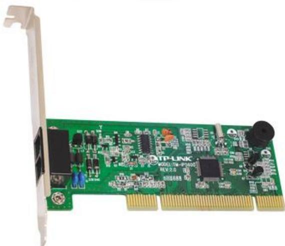
Наиболее распространены сейчас модемы со скоростями 28800, 33600, 56000 бод (бит в секунду), но уже выпускаются и такие, которые обеспечивают более высокую скорость обмена.
