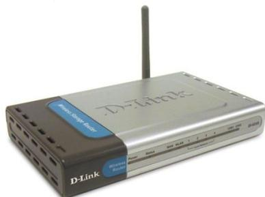
Скорость обмена данными до 11 Мбит/с при подключении точка-точка и до 54 Мбит/с при инфраструктурном соединении.
